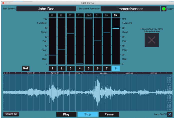
Abb. 4, User Interface zum Testprogramm des MUSHRA Tests
